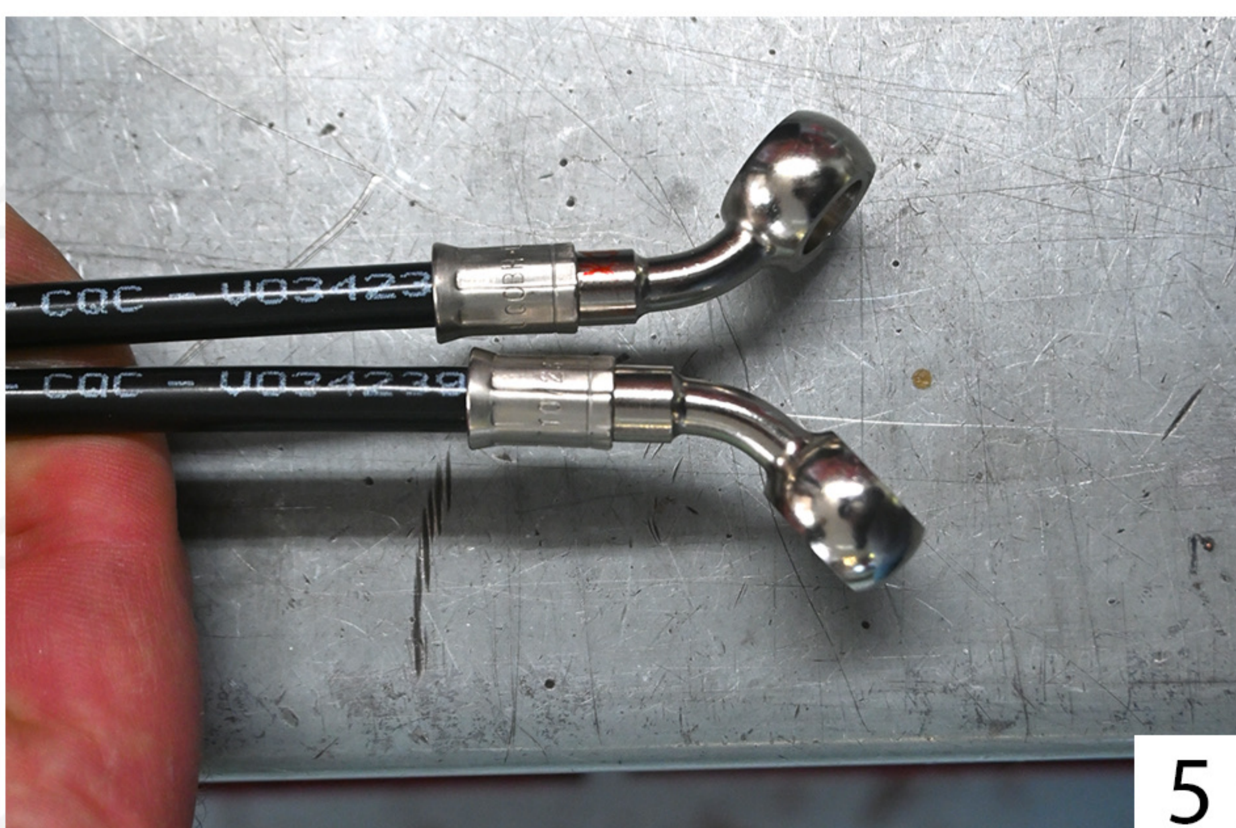
Il tubo SX è il tubo freno +4mm rispetto al DX, montare il tubo SX e chiudere (img.5); montaggio tubo SX (img.6); accertarsi che i tubi siano montati come in foto (img. 7), montare il tubo DX nella stessa maniera; SX pipe is the brake pipe +4mm than the DX pipe, mount the SX pipe and close (img.5); mount pipe SX (img.6); make sure the pipes are mounted as in the photo (img. 7), mount the RIGHT pipe in the same way;
