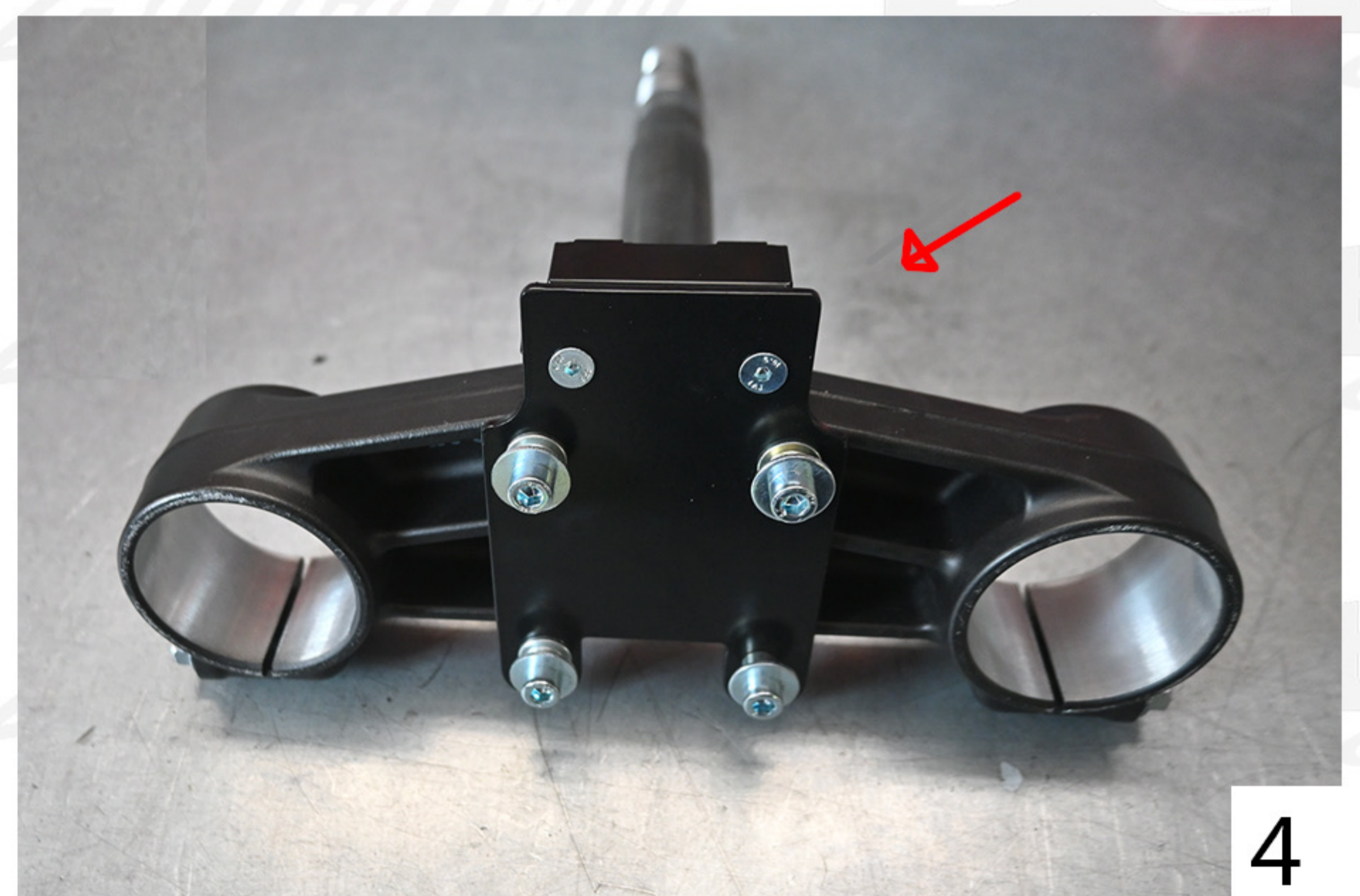
Il ripartitore è posizionato nella parte posteriore della piastra (img.3), ATTENZIONE se non si acquista il KIT A, i bulloni parafango, boccole e rondelle non sono inclusi. Si possono acquistare separatamente. Assicurarsi che il ripartitore sia allineato nella parte posteriore (img.4); The splitter is located at the rear of the triple clamp (img.3), CAUTION if you do not purchase KIT A, the fender bolts, bushings and washers are not included. They can be purchased separately. Make sure that the splitter and tripleclamp are aligned at the rear (img.4)
